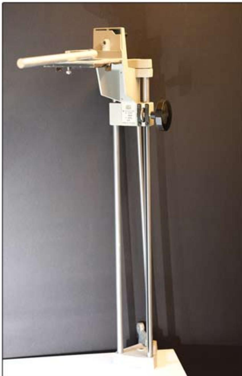
La colonne d'un vieil agrandisseur est idéale comme potence, car on peut la régler en hauteur. Plus la hauteur de la vanne électronique est importante, plus la colonne d'eau ascendante sera élevée si l'intervalle de temps entre les gouttes est assez ralenti. La photo ci-contre a été prise avec la colonne montée au maximum (environ 80 cm).
