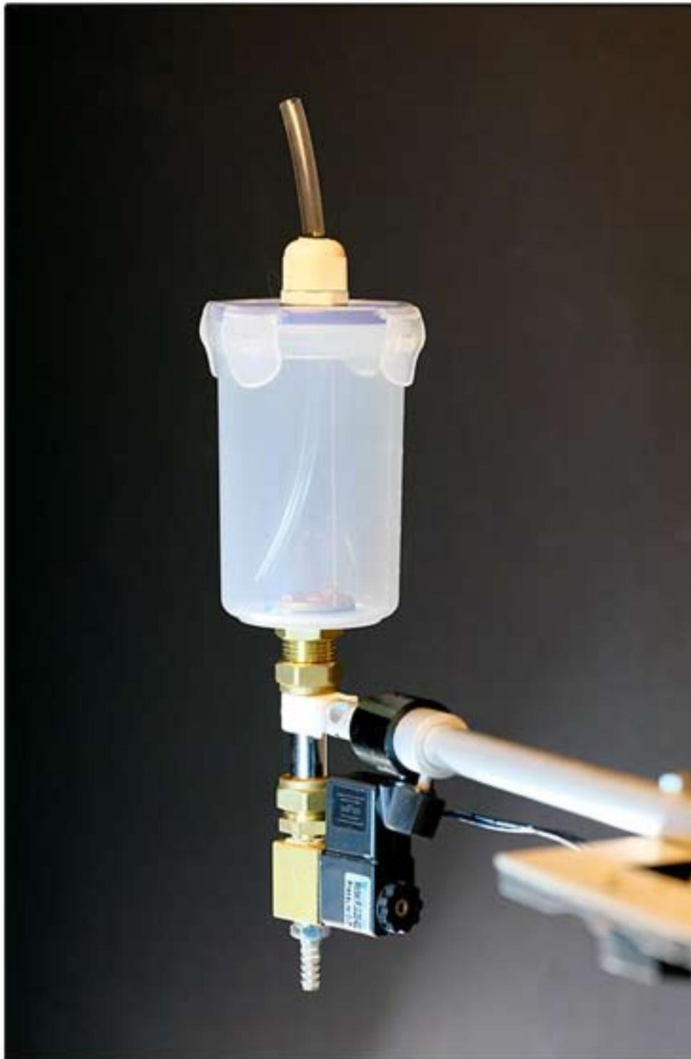
Le goutte-à-goutte commandé par le boîtier électronique est constitué en haut d'un réservoir dans lequel on met de l'eau, si possible distillée et sans additif, au milieu d'un solénoïde (ici en noir) et en bas d'une buse en cuivre. Attention, le calcaire et les additifs peuvent boucher cette buse. Un peu de vinaigre blanc peut être ajouté à l'eau si on n'a pas d'eau distillée.
